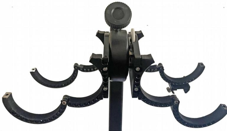
Die Schellen werden mit je zwei M4 Zylindersechskantschrauben an der BM-100 fixiert. Diese Verschraubung erfolgt parallel zur optischen Achse, einmal von hinten und einmal von vorne. Weiter sind je Schelle je zwei Stiftschrauben vorhanden (ebenfalls M4) mit denen dann der jeweilige Tubus feinjustiert werden kann.
