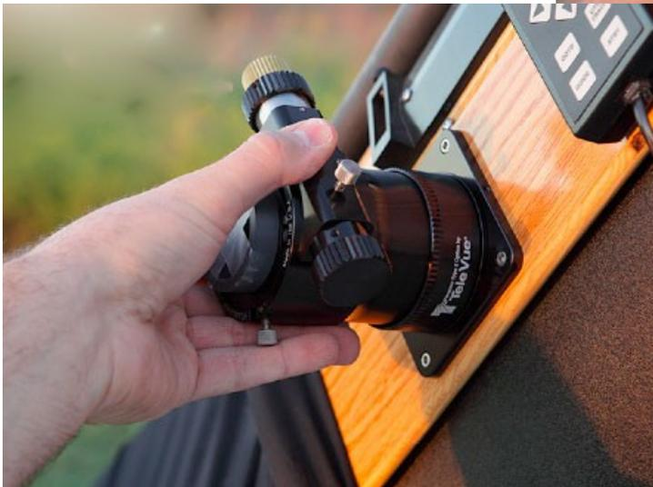
Ist das Abbild des Objektes auf dem Klebstreifen (Mattscheibe) scharf gestellt, können Sie die gefundene Position mit drehen des unteren Ringes am SIPS Element fixieren. Danach können Sie den Auszug wieder richtig positionieren, indem Sie die kleinen Imbusschrauben lösen und den Auszug korrekt gedreht wieder fixieren.
