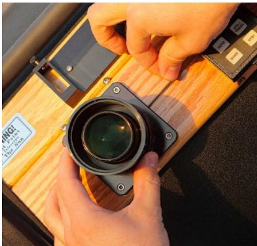
Setzen Sie anschliessend das SIPS Element auf die Montageplatte und fixieren Sie dieses mit Hilfe der kleinen Imbusschrauben wie abgebildet.
