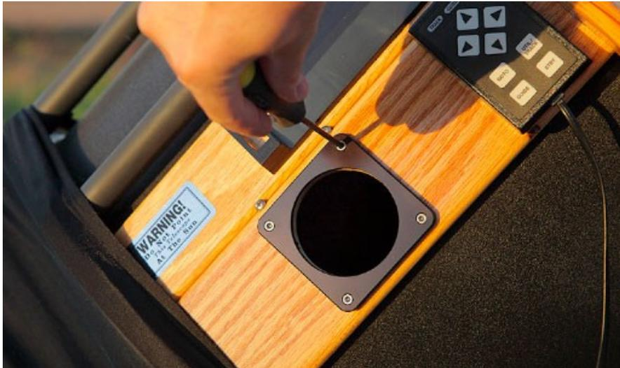
Fixieren Sie das SIPS wie abgebildet an der Montageplatte mit Hilfe der kleinen Imbusschrauben.
